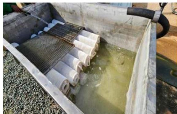
**Gambar 6.15** Dokumentasi Pelaksanaan Program Menurunkan Kehilangan *Raw Condensate* dengan Memperpanjang *Running Service Cartridge Filter Reverse Osmosis* di Pabrik 5
